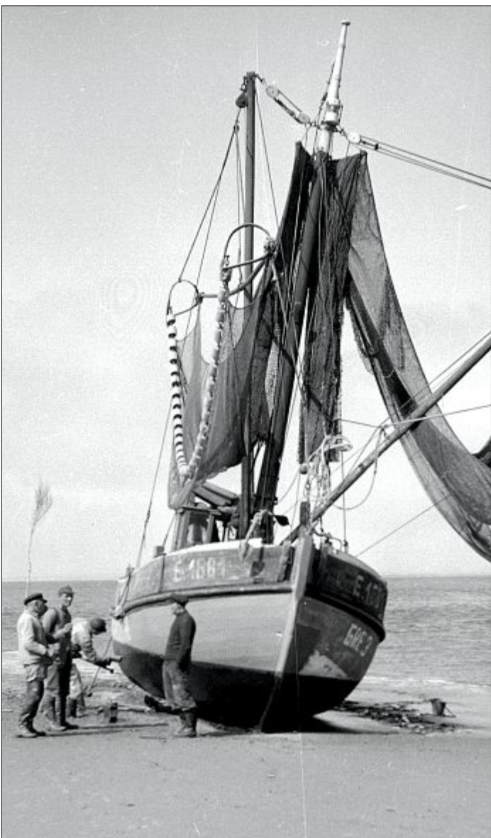
Trockenfallen zur Kielreinigung eines Fischkutters.
